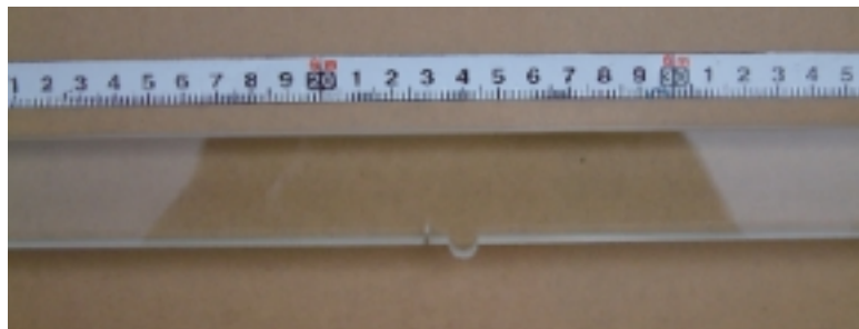
図2 光弾性超音波可視化法に用いた試験片
