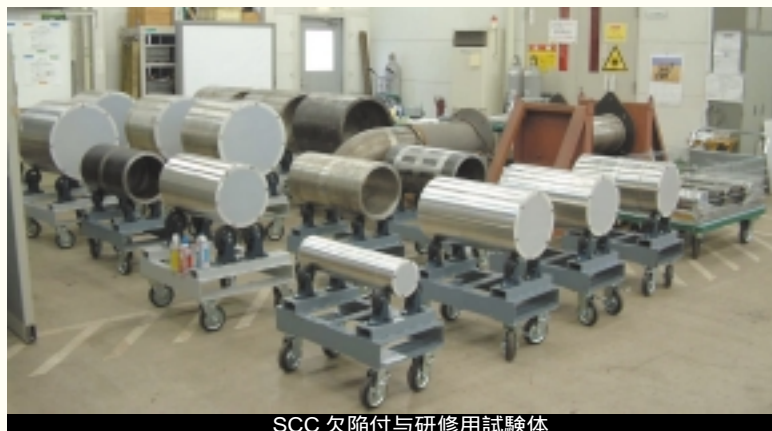
SCC欠陥付与研修用試験体
