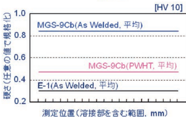
図1 PWHTの有無に伴う改良9Cr-1Mo系鋼溶接部の機械的特性の違い(E-1は炭素鋼)
