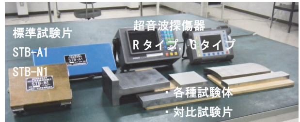
図3 UTレベル2実技研修用機材(探傷器, 試験体等)の例
