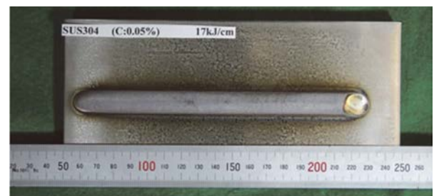
図1 SUS304溶接試験体の外観
