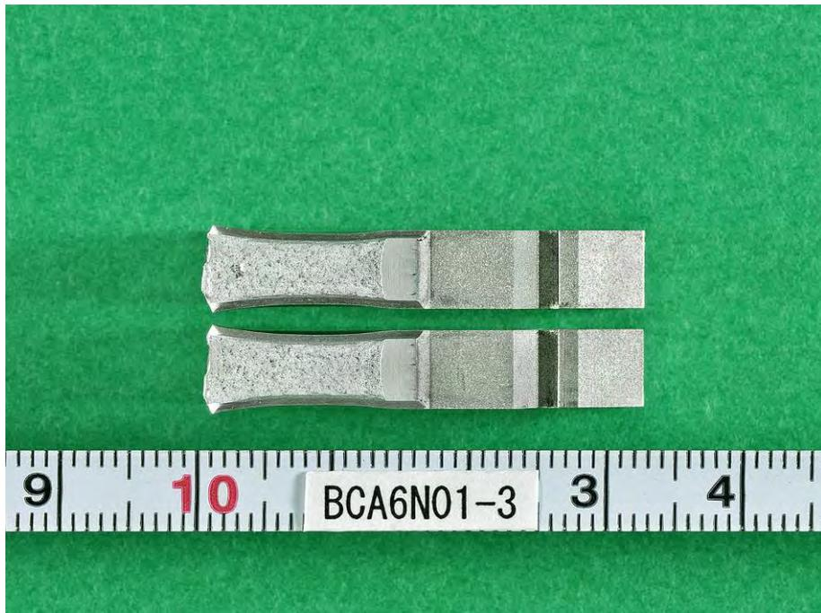
図 167 試験片の破面状況
