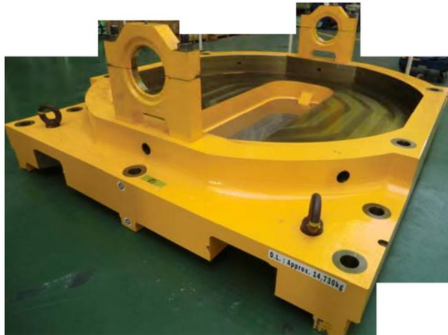
(b) 実規模貯蔵架台の例
