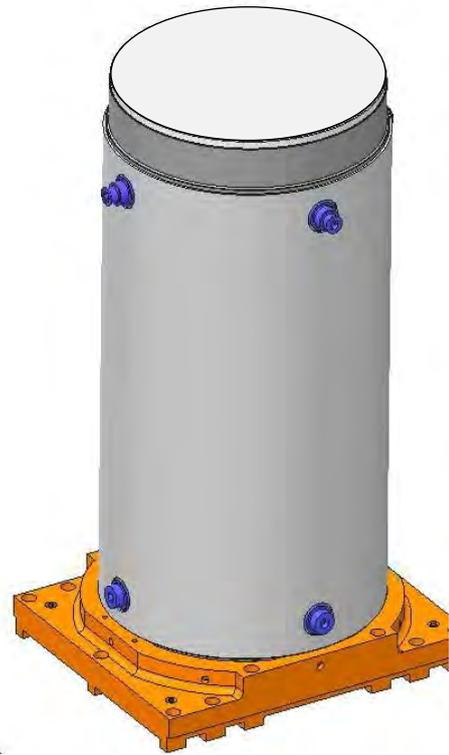
縦置き状態図（エアパレット（搬送装置）込）
