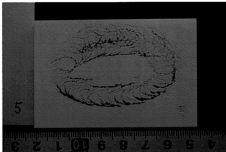
図⑨-2 現像時間後の常温での浸透探傷試験結果
