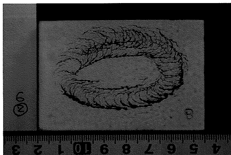
図⑨-4 現像時間後の低温 2 での浸透探傷試験結果
